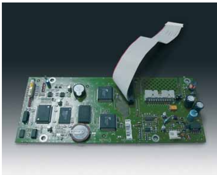
Ursprüngliche Elektronikbaugruppe in herkömmlicher Bauart mit der Trennung analoger und digitaler Bauelemente
