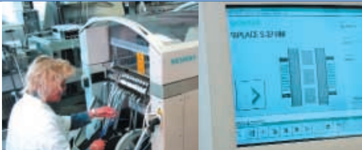
Einfaches Handling: Sartorius-Mitarbeiterin bei der Einrichtung einer SIPLACE SMD-Linie.
